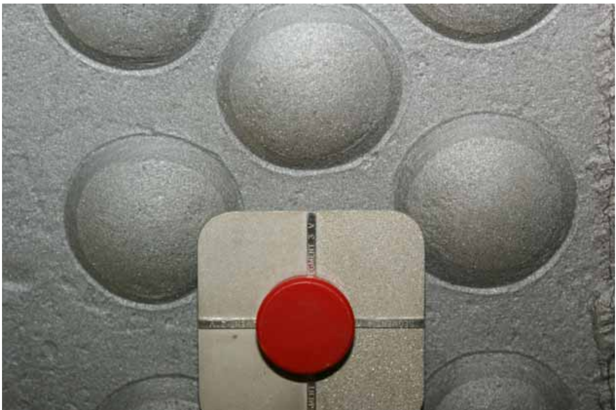
Bild: Sandstrahlabnahme im verbleibenden alten Teil der inneren Verteilrohrleitung-Flachstrecke. Die Staubfreiheit wird mittels Klebebandtests auf die Erreichung des Reinheitsgrades m^2/g^2 geprüft (DIN EN ISO 8502, Teil 3).
