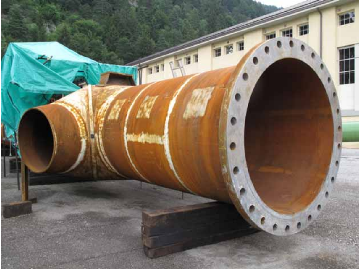
Bild: neues Verteilrohrleitungsstück vor der Sandstrahlung.
