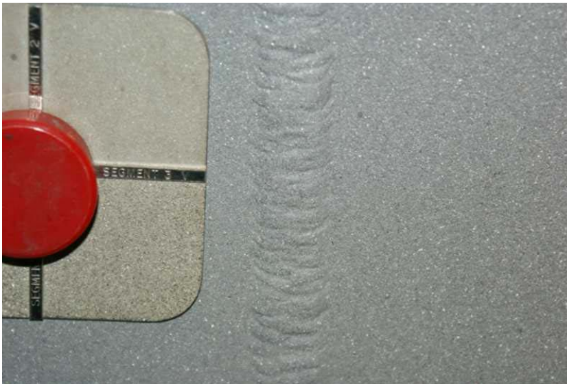
Detailaufnahme von der gereinigten Oberfläche mit ISO-Rauhigkeits-Vergleichsmuster.
